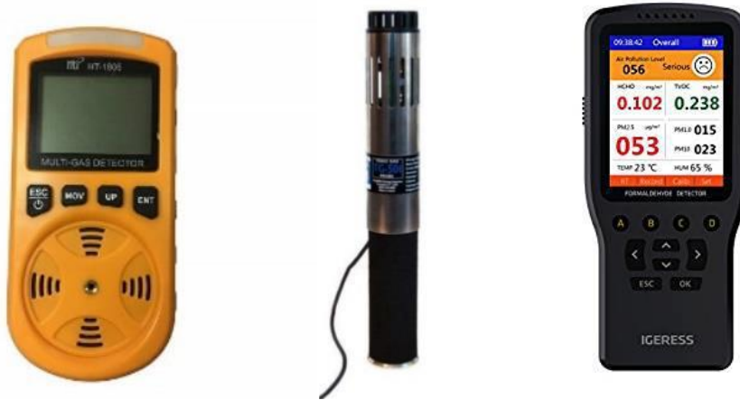
Figure 14 : Les détecteurs utilisés pour la mesure de la qualité de l'air (source auteur 2024)
